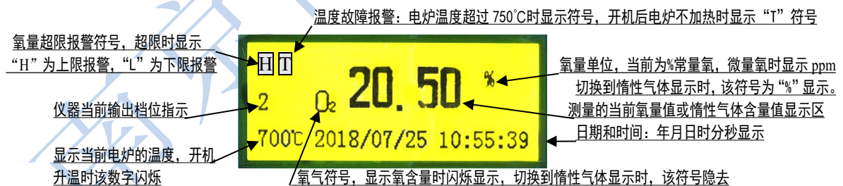
图 7 仪器的液晶显示屏及显示的字符含义
