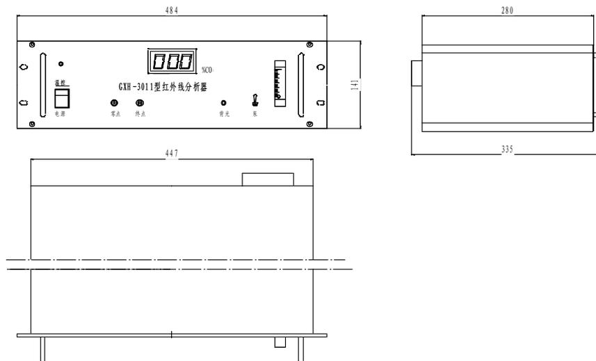
图三 仪器尺寸及开孔尺寸
