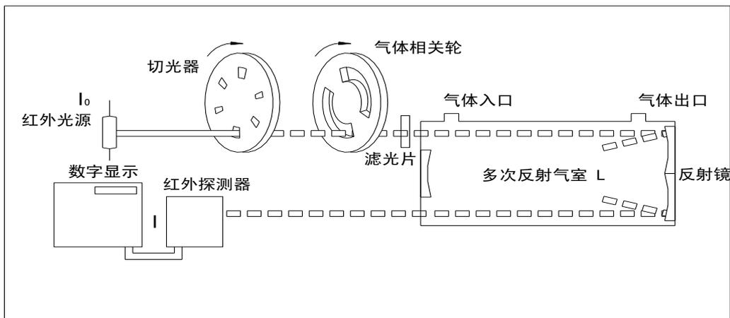
图一、气体滤波相关红外线光学部件示意图
