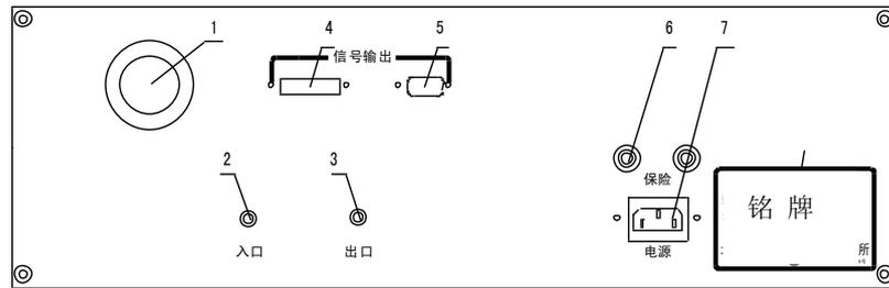
1.观察过滤器 2.入口 3.出口 4.4~20mA 信号输出接点 5.数字信号接点 6.保险 7.电源插座
